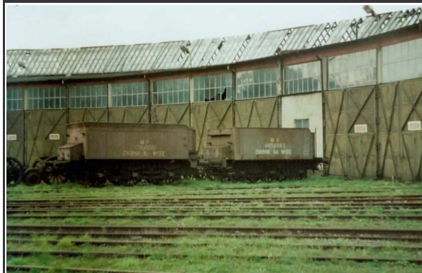
Tendry przerobione na zbiorniki przeciwpożarowe
